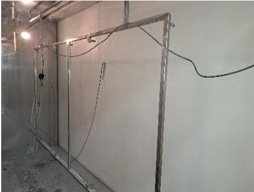
Figure 3. Enceinte d'essai pour cycles hygrothermiques
