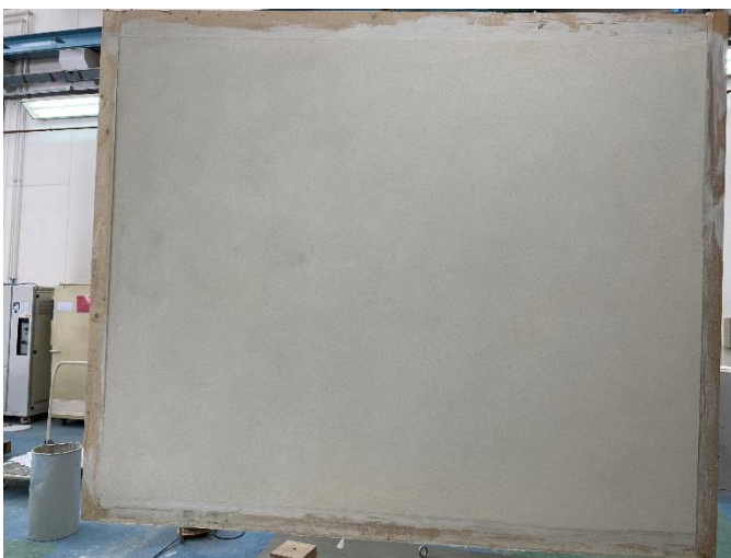
Figure 4. Maquette 1 avant cycles chaleur-pluie
