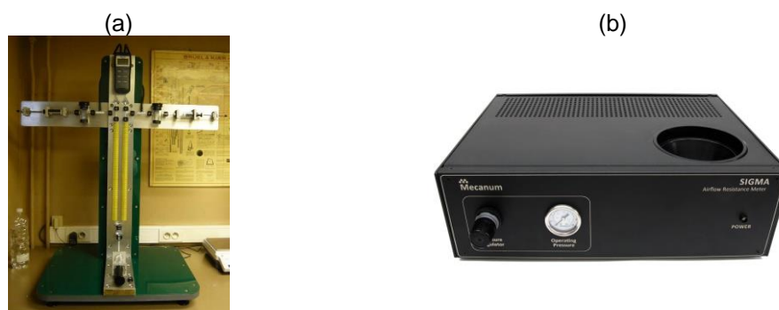
Figure 7-2 : Dispositifs de mesure de la porosité (a) et de la résistivité (b).
