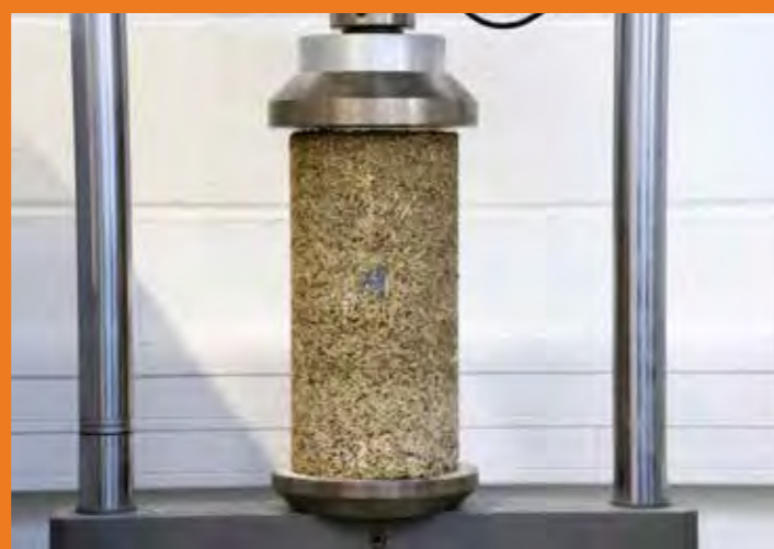
Essai à la compression / béton de chanvre
